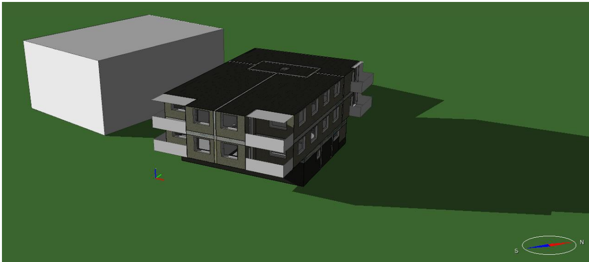
Abbildung 1: Dreidimensionales Gebäudemodell Dafins V182 Haus B mit dem verschattenden Nachbargebäude aus der Software IDA ICE.
