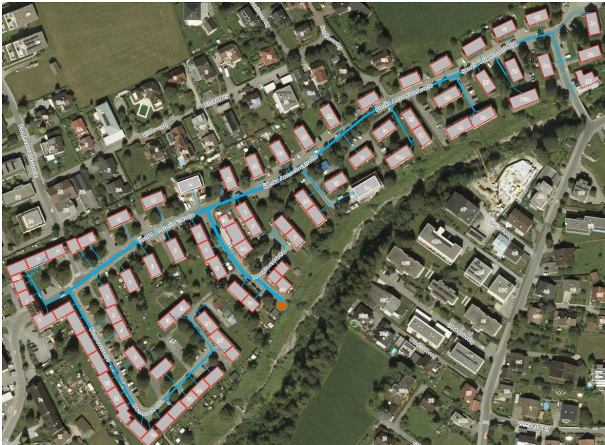
Abbildung 3: Betrachtete Gebäude und potentielle Trassenverläufe und Gebäudeanschlussleitungen
