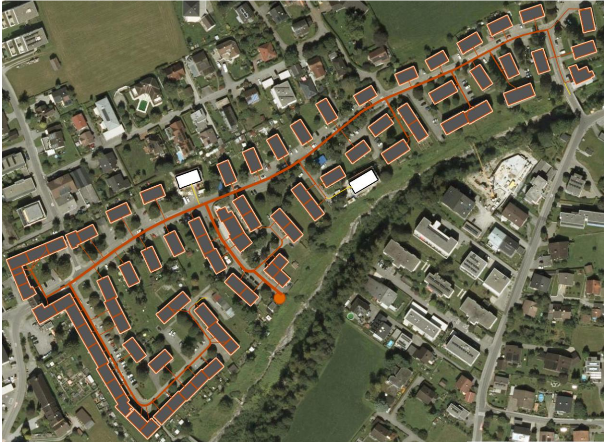
Abbildung 4: Grafisches Ergebnis der optimalen Trassenführung und Netzauslegung
