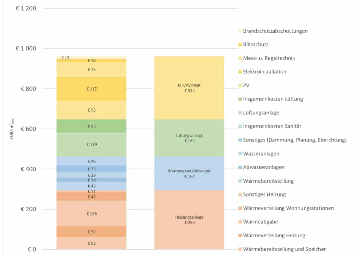
Abbildung 207: Abgerechnete, wohnflächenspezifische Netto-Kosten der Haustechnikmaßnahmen für die Ausführungsvariante des großen Gebäudes in EUR/m² WNF
