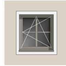
FENSTER NEU 2023 - (V3) 1 Flügel mit Sprossen, Profil IV85, 3-fach-Verglasung Vorstellung mit historischem Bezug
