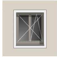
FENSTER SANIERUNG 1970 2 Flügel, Profil IV85, 3-fach-Verglasung
