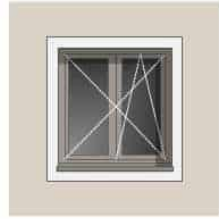
FENSTER NEU 2023 - (V1) 2 Flügel, Profil IV85, 3-fach-Verglasung Aktuelle Planung
