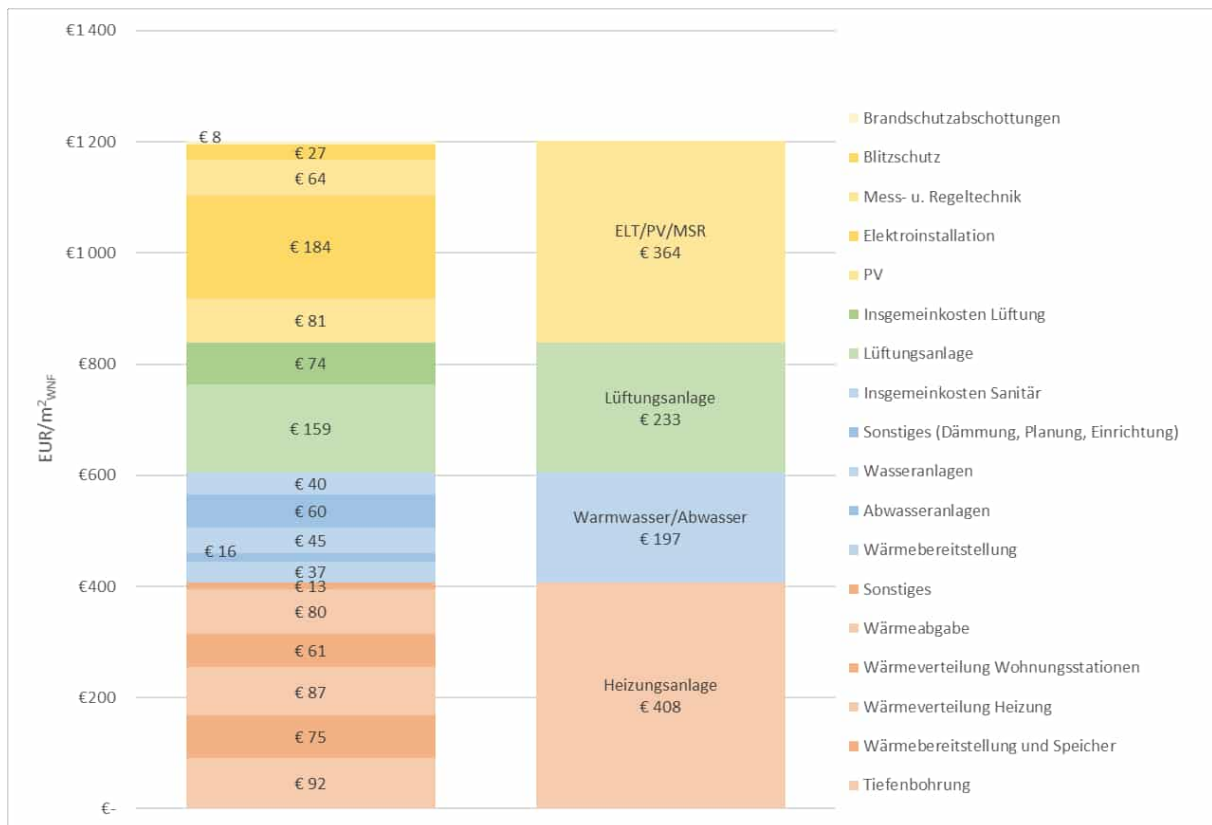
Abbildung 209: Abgerechnete, wohnflächenspezifische Netto-Kosten der Haustechnikmaßnahmen für die Ausführungsvariante des kleinen Gebäudes in EUR/m² WNF
