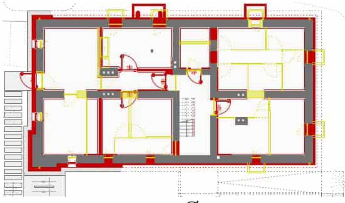
Abbildung 145: kleines Gebäude, Grundriss KG, Veränderungen gegenüber Bestand, ohne Maßstab; gelb: Abriss, rot: neues Bauteil, neue Bauteilschicht/Komponente, grau: Bestand; Johannes Kaufmann und Partner GmbH
