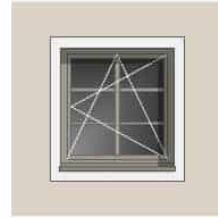
FENSTER NEU 2023 - (V2) 1 Flügel mit Sprossen, Profil IV85, 3-fach-Verglasung Vorstellung mit historischem Bezug
