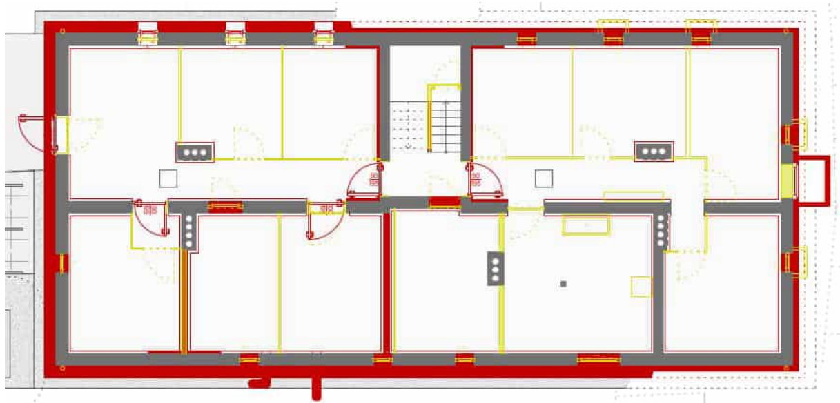
Abbildung 78: großes Gebäude, Grundriss KG, Änderungen gegen Bestand, ohne Maßstab; Johannes Kaufmann und Partner GmbH; gelb: Abriss, rot: neues Bauteil, neue Bauteilschicht/Komponente, grau: Bestand
